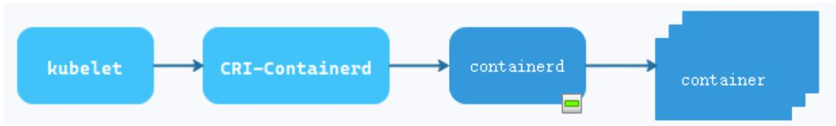
上面 `cri-containerd` 和 `containerd` 还是独立的两个进程。他们之间通过 gRPC 通信，为了进一步减少了调用链，提高运行效率，后来在 `containerd` V1.1 时，将 `cri-containerd` 改成了 `containerd` 的 CRI 插件，这让 k8s 启动容器的过程更加高效，此时 k8s 节点上 kubelet 启动容器的流程大概如下：
