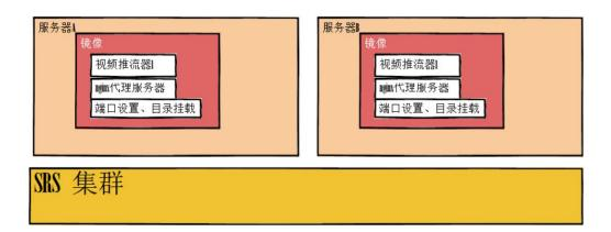
每个视频服务生成一个镜像,镜像会映射多个端口。因为视频服务推流是多 线程设计,每个服务器没有必要去部署多个镜像去管理。如果压力比较大,视频 服务镜像与 SRS 分开部署,SRS 集群部署。
